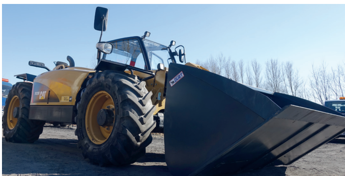
Do gminnej spółki docierają już kolejne urządzenia, które będą wykorzystywane do produkcji dróg betonowych, m.in. ładowarka teleskopowa
